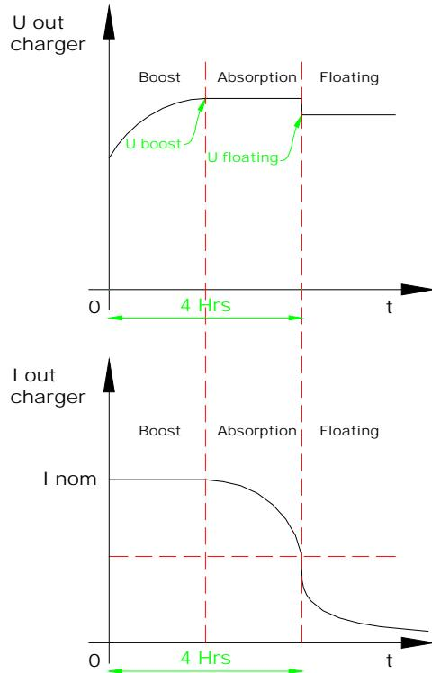
Fase Boost: arranca automáticamente cuando se pone en tensión del cargador si la batería está descargada. Entonces la corriente es máxima.
