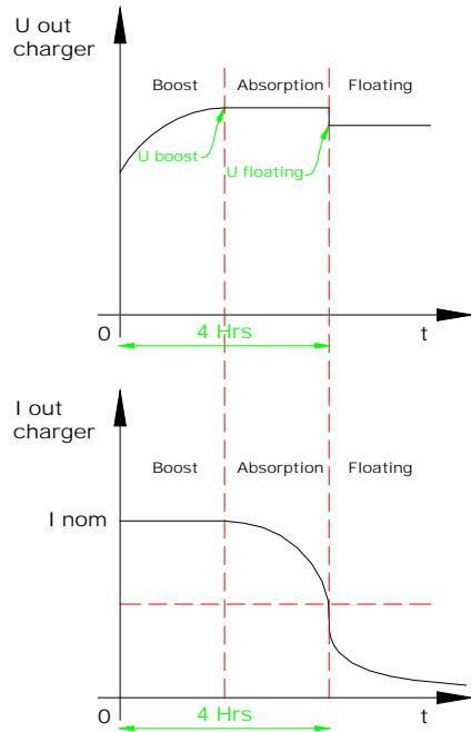
Boost-Phase: startet automatisch bei Unterspannungsetzen des Ladegerätes, wenn die Batterie entladen ist. Der Strom ist hierbei maximal.
