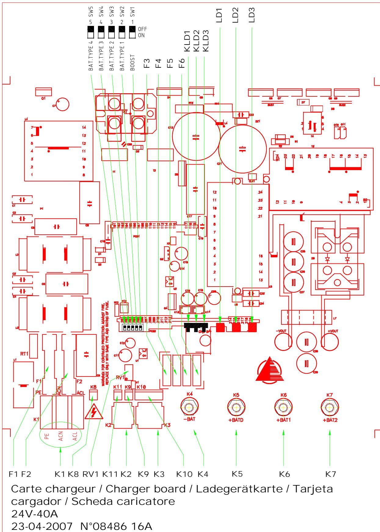
Chargeur 3 Sorties / 3 Output charger / Ladegerät 3 Ausgänge / Cargador 3 salidas / Caricabatteria 3 Uscite
