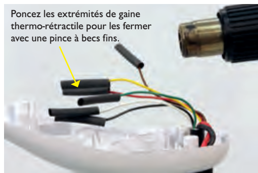
FIGURE 20 Isolez et fermez les six fils d' AutoPilot sur les moteurs de Riptide SP avec la gaine thermo-rétractable fournie.
