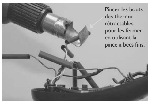
FIGURE 16 Isolation et fermeture des six fils d'AutoPilot (Pilote automatique) sur moteurs Riptide SP avec le thermo rétractable fourni.
