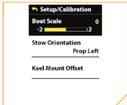
5. Utilisez le bouton Virage à gauche ou Virage à droite pour régler l'échelle du bateau sur l'un des cinq réglages : -2, -1, 0, 1 ou 2.
