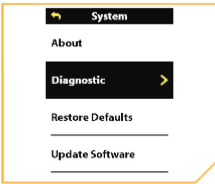
4. Utilisez les boutons Accélérer ou Ralentir pour rechercher les codes d'erreur. Appuyez sur le bouton Tourner à droite pour sélectionner les codes d'erreur.
