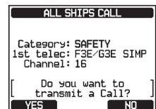
5. Après avoir émis l'appel à tous les navires, l'émetteur-récepteur passe sur le canal sélectionné.
