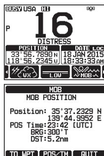
3. Pour émettre un message de détresse ASN, soulevez le couvercle rouge DISTRESS à ressort situé sur côté droit de l'émetteur-récepteur, puis appuyez sur la touche **DISTRESS** et maintenez-la enfoncée (voir la section "**10.2.1 Émission d'une alerte de détresse ASN**" pour plus de détails).
