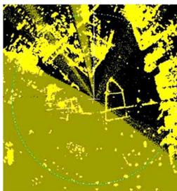
En cas de beau temps, le niveau de gain est généralement réglé près des valeurs maximales. En cas de mauvais temps, comme de fortes pluies, de la neige ou une mer agitée, il est nécessaire de régler non seulement le niveau de gain, mais aussi la fonction de suppression des échos de la mer et la fonction de suppression des échos de la pluie/neige. Vous devez choisir un niveau approprié,
