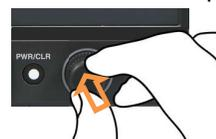
Appuyez sur l'icône GAIN, ou poussez le bouton rotatif lorsque l'icône GAIN est focalisée.
