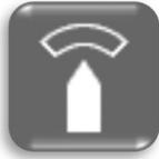
Fonction de zone de garde utilisée pour détecter un mouvement d'écho dans la zone d'avertissement. Zone de garde peut être définie comme dans-alarme ou dehors-alarme ou AUTO-TT (auto-TT).
