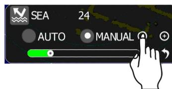
Vous devez ajuster le niveau de la mer tout en surveillant l'écho radar en mode TX.
